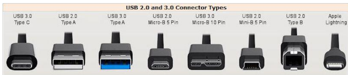
Figura 30. Comparativa de conectores USB.
